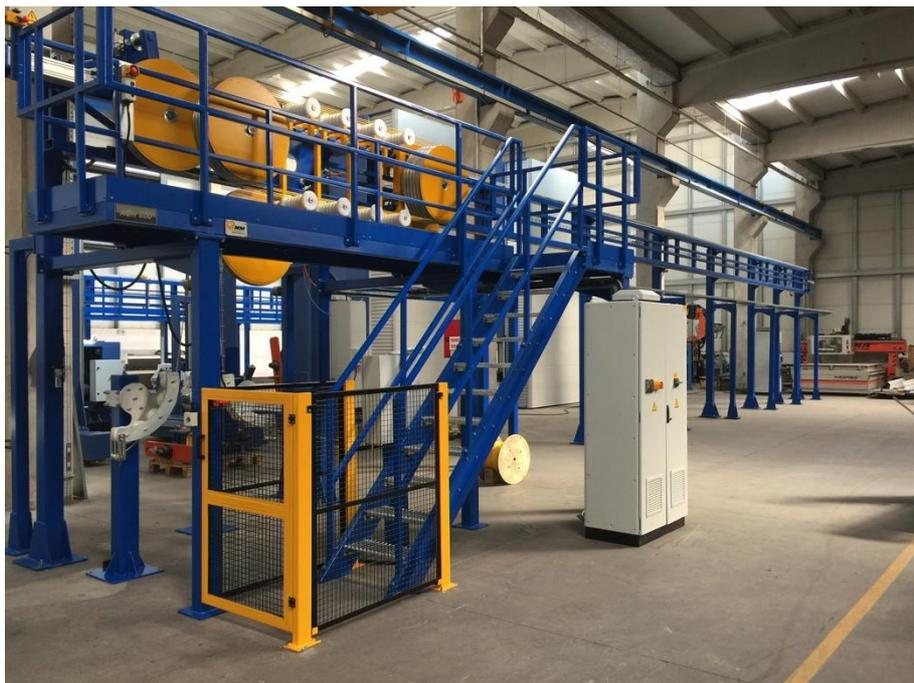
Pantin pneumatique intégré avec contrôle de la tension du câble
