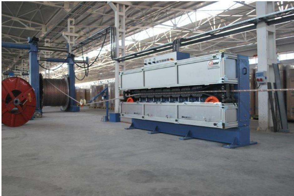
Modèle de chenille autonome pour câble sous-marin avec entraînement intégré et générateur d'air comprimé.
