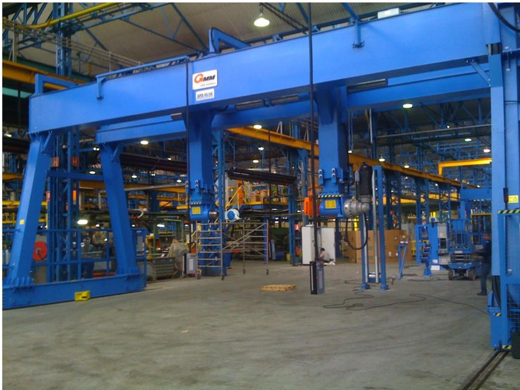
Modèle Gantry non mobile. Bobines jusqu'à 5000mm, 60 tonnes.
