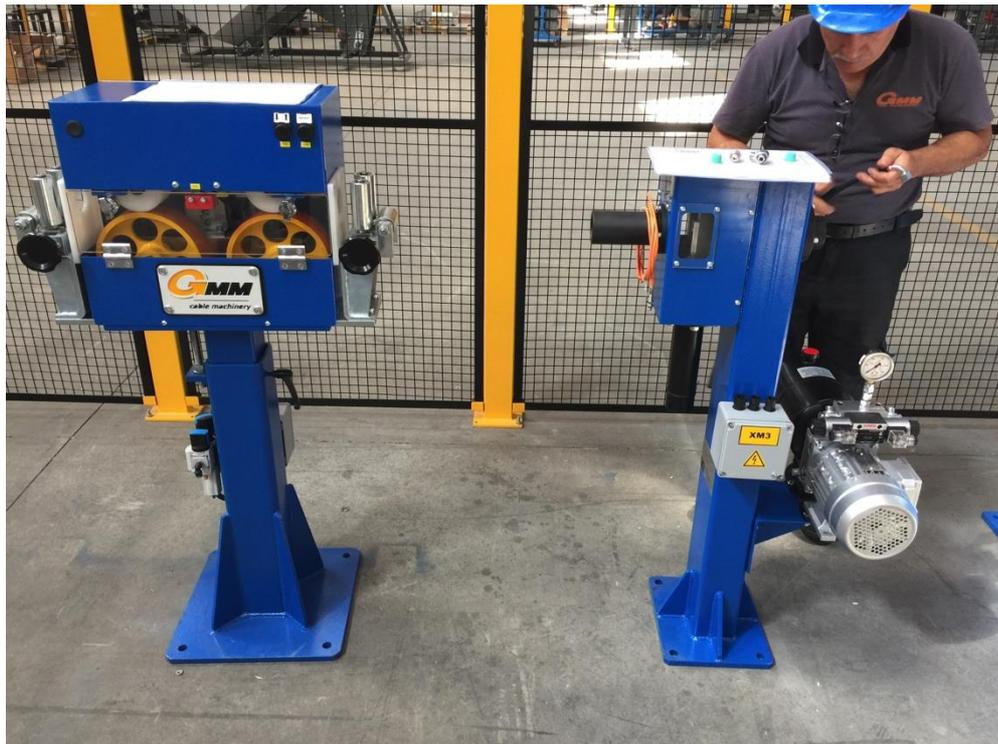
Dispositif de coupe de câbles haute tension
